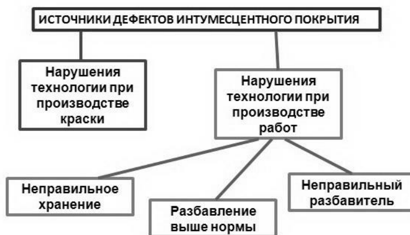
Рис. 1. Причины нарушения интумесцентной огнезащиты
