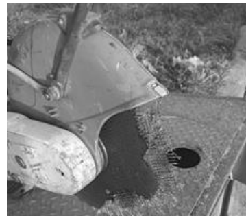
Рис. 2. Разрыв абразивного круга при резании металлических поверхностей
