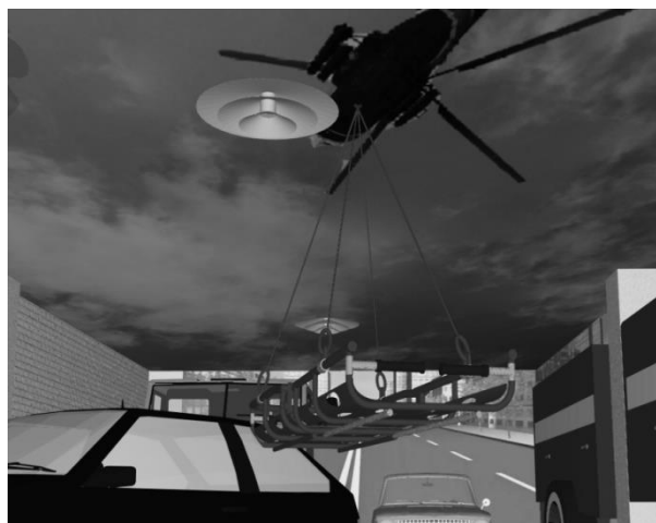
Рис. 8. Изображение закрепления носилок с помощью универсальных носилок «Спайдер» и подъемно-спусковой лебедки
